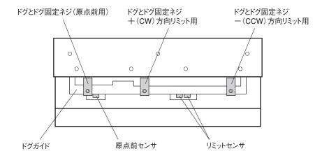
原点前センサの検出位置は中央付近(工場出荷時)に調整されており、通常調整する必要はありません。ただし、QTシリーズコントローラでモータ回転方向の選択(パラメータNo.18)を逆転にした場合は原点復帰位置が変わります。本製品は、以下の調整手順で原点復帰位置を中央付近に調整することができます。
