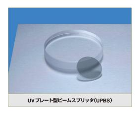
合成石英ガラスを基板に採用し、研磨加工により板厚を薄くするとともに、基 板の面精度の高さも両立させた高性能プレート型ビームスプリッタです。 250-450mの紫外域で機能するプレート型ビームスプリッタを用意しました。基 板の表面側には所定のR/T分割を実現するための誘電体多層膜、また裏面には不 要な戻り光を低減し、スループットを最大限に改善するマルチARコートが施され ています。
