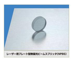
特定のレーザー発振波長に最適化したプレート型の無偏光ビームスプリッタです。 無偏光タイプのため、50R/50Tのビーム分割は、入射する光の偏光状態に依存し ません。基板の表面側には50R/50Tを実現するための誘電体多層膜、また同裏面 側には不要な戻り反射を低減し、スループットを最大限に改善する狭帯域マルチ ARコーティング(Vコート)が施されています。基板には熱安定性に優れ、超低自 家蛍光性を有する合成石英ガラスを採用。また表面品質や平行度など、厳格に管 理した製造品質により、透過波面精度を1/10λ以下に抑えます。
